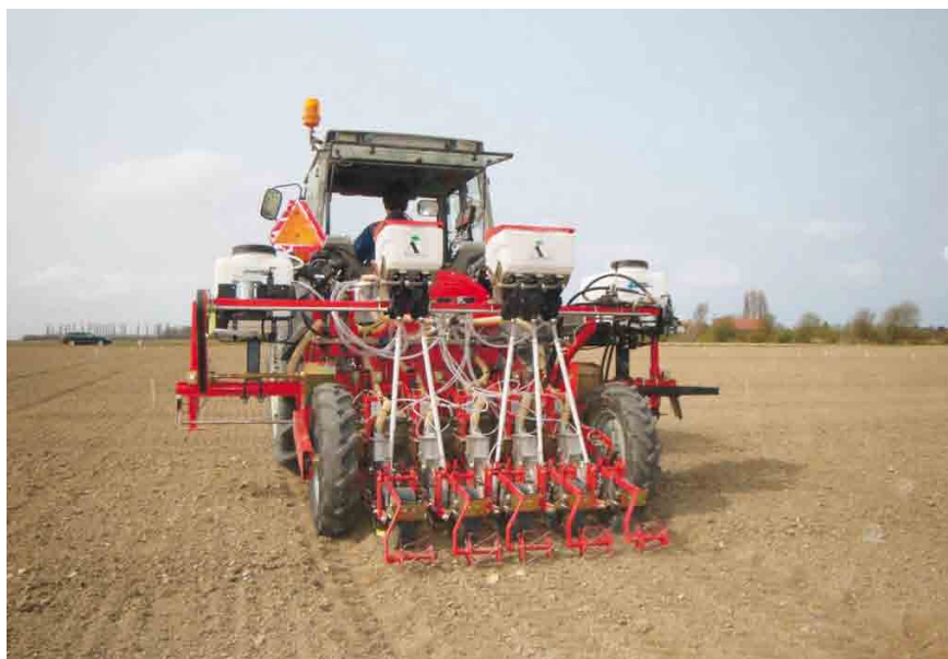
De rassenproef wordt gezaaid met een speciale proefveldmachine met 5 rijen op een bed van 1,50 m.
