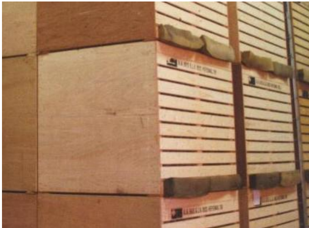
Combi droogkist voor éénlaag beluchting; voorkant latten, zijkant plaatmateriaal.
