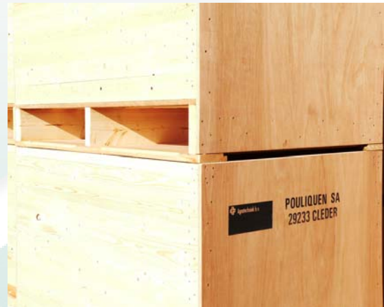
Luchtuitlaat aan zijkant tussen kistlagen. Drogen per kistlaag gescheiden.
