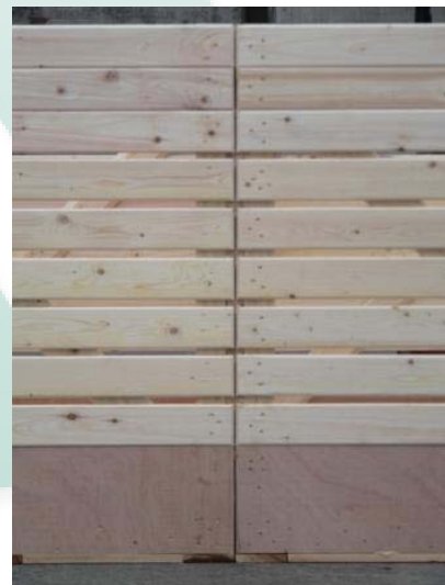
Lattenkisten voor zuigsystemen; Kieren tussen de kisten zijn gesloten. Meer lucht door het product.
